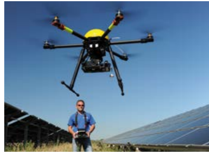
Seit 2015 nutzen wir eine Drohne, um die Funktionsfähigkeit von Photovoltaikanlagen zu überprüfen. Aufnahmen einer an der Drohne installierten Wärmebildkamera geben sofort Aufschluss über den Zustand der Solarmodule.
