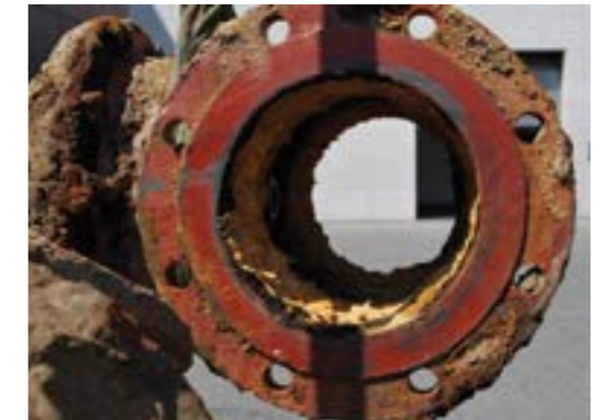
▲ So sieht ein rund 40 Jahre alter Wasserschieber aus, der seinen Geist aufgegeben hat.
